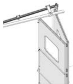
Wings folding to 90° Pliage du vantail à 90° Doble de la hoja a 90°
