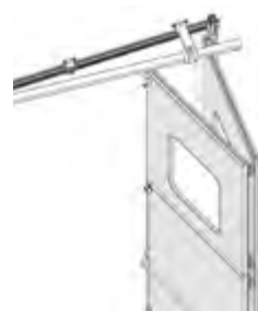
Ribaltamento ante a 90° Wings folding to 90° Faltung des Flügels zu 90°
